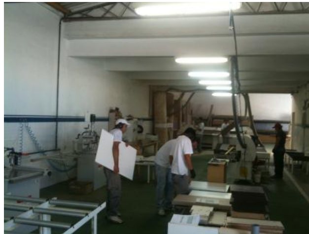
Figura 2 – Layout da fábrica – máquinas próximas para evitar desperdício no transporte
